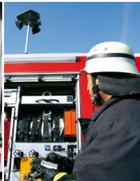
links: Auszug im Geräteraum G2    mitte: An Kleinlöschgeräten werden ein Feuerlöscher PG 12 (hinten) und ein Kleinlöschgerät MicroCAFS mitgeführt.    rechts: Der pneumatisch ausfahrbare Lichtmast ist mittels einer Kabelfernsteuerung bedienbar.
