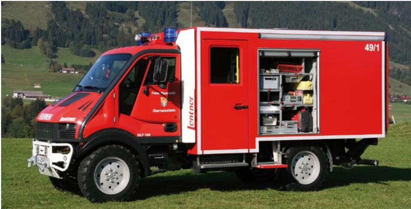
Der Geräteraum G1 ist im Vergleich zum Geräteraum G2 deutlich kleiner, um im Heckbereich Platz für die Rollcontainer zu schaffen.
