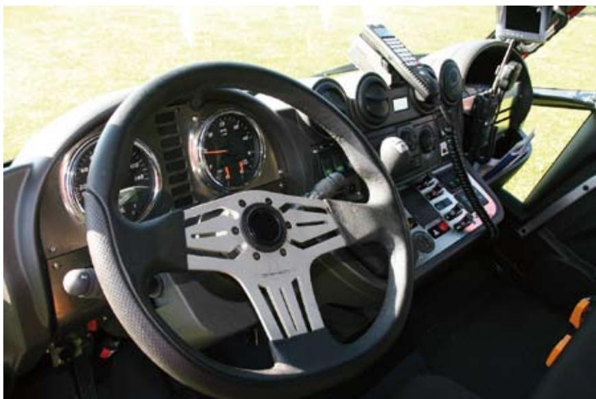
Blick in den Fahrerraum. An der Beifahrer-A-Säule ist der Monitor der Rückfahrkamera montiert.
