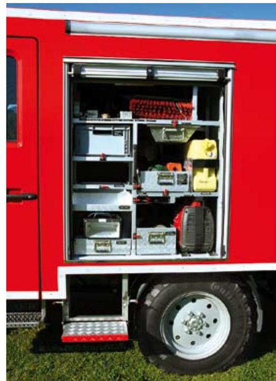
*Der Geräteraum G1 ist vor allem Gerätschaften zur einfachen Technischen Hilfeleistung vorbehalten. Der unten rechts mitgeführte Stromerzeuger hat eine Leistung von 2 kVA.*
