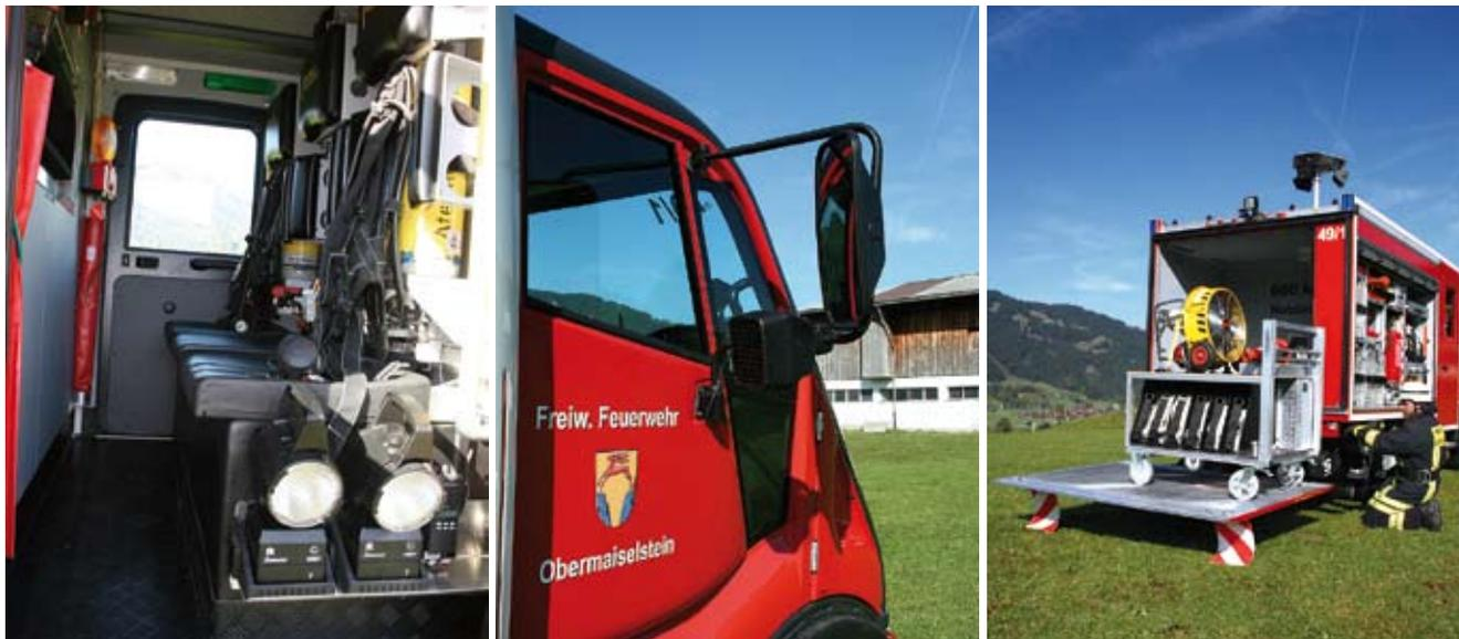
**links:** Alle drei Plätze des Mannschaftsraums sind mit Halterungen für Pressluftatmer ausgestattet. **mitte:** An den Rückspiegeln sind Manövrierscheinwerfer montiert. **rechts:** Auf der Landebordwand befindet sich der Standard-Rollcontainer zur Ergänzung der Normbelastung.
